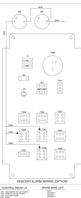
CR1 - SECONDARY 48V DC POWER CR2 - PRIMARY 48V DC POWER CR3 - AUXILARY PUMP CR4 - HORN CR5 - BRAKE RELEASE CR10A - PLATFORM LEVEL CUTOUT (CE ONLY) CR10B - PLATFORM LEVEL CUTOUT (CE ONLY) OPTION NUMBERS
